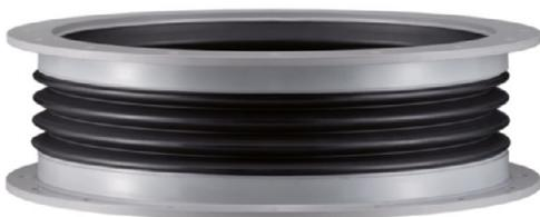
Wellflexmanschetten 3 mm stark sind 6-fach gewellt und werden von DN 110 bis DN 1400 angeboten. Wellflexmanschetten 6 mm stark sind 4-fach gewellt und von DN 450 bis DN 1400 lieferbar. Alle Wellflexmanschetten sind mit Muffen- oder Flanschanschluss sowie für die Befestigung mit Spannband erhältlich.
