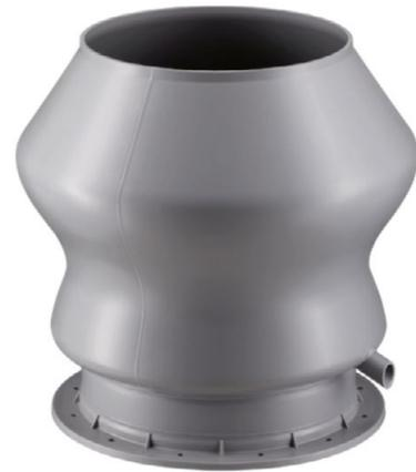
Die Beck Deflektorhauben DSB sind aufgrund ihres geringen Druckverlustes ideal zum Abschluss senkrechter Ausblasleitungen geeignet. Eintretendes Regenwasser wird durch den Traufwasserstutzen sicher nach außen abgeleitet. Die glatte und nahtlos verformte Oberfläche im Inneren der DSB Hauben beeinflusst das Strömungsverhalten der Abluft maßgeblich und führt zu einer erheblichen Reduzierung des Druckverlustes.
